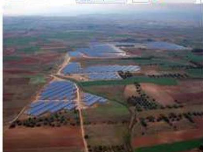
Compie un anno la serra fotovoltaica piu' grande al mondo, realizzata a Villasor, nel sud Sardegna, a 25 km da Cagliari. "Su Scioffu" e' un mega impianto da 26 ettari con una capacita' installata di 20 MWp, pari al consumo annuale di 10.000 case, con un risparmio di 25 mila tonnellate di CO2 (il risparmio di una foresta di 3.200 ettari).
